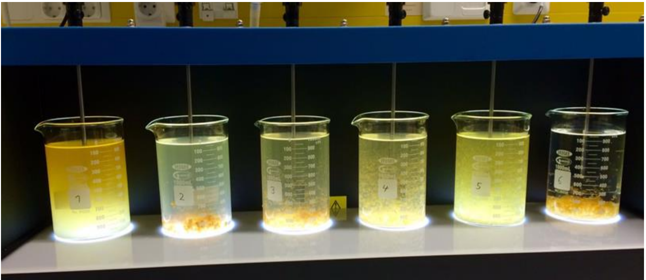
Kuva 1. Jar-testilaitte. Laittimmaisessa astiassa vasemmalla on käsittelemätöntä Ruukin pelto-ojan vettä, muissa eri biopolymeereillä käsiteltyä vettä. Kuva: Jarno Turunen.
